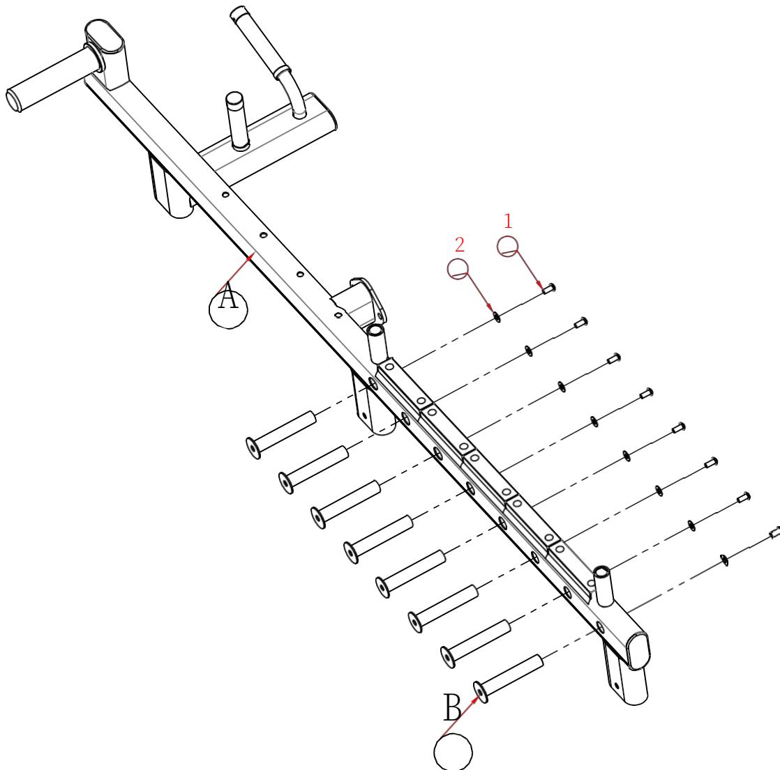
Schritt 1: (Ziehen Sie nicht alle Schrauben an, sondern erst nach Abschluss der Installation) 1. Montieren Sie 2 linke und rechte untere Querrahmenbaugruppen A und 14 kleine Riegelbaugruppen wie in der Abbildung gezeigt, und befestigen Sie sie mit 14 1# Innensechskantschrauben M10\*20 und 14 2# Ø 10 Unterlegscheiben. Die Installationsmethode ist auf beiden Seiten gleich.
